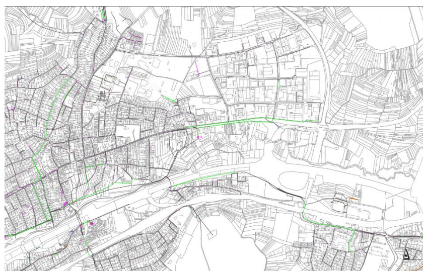
Abbildung 17: Kartografische Darstellung der bestehenden Haupt-Abwasserleitung DN >750 (grün) 2/2
